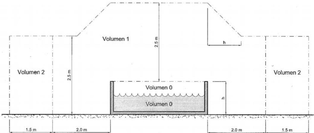
Figura 3. Dimensiones de protección en piscinas con paredes de altura mínima 2,5 m.
