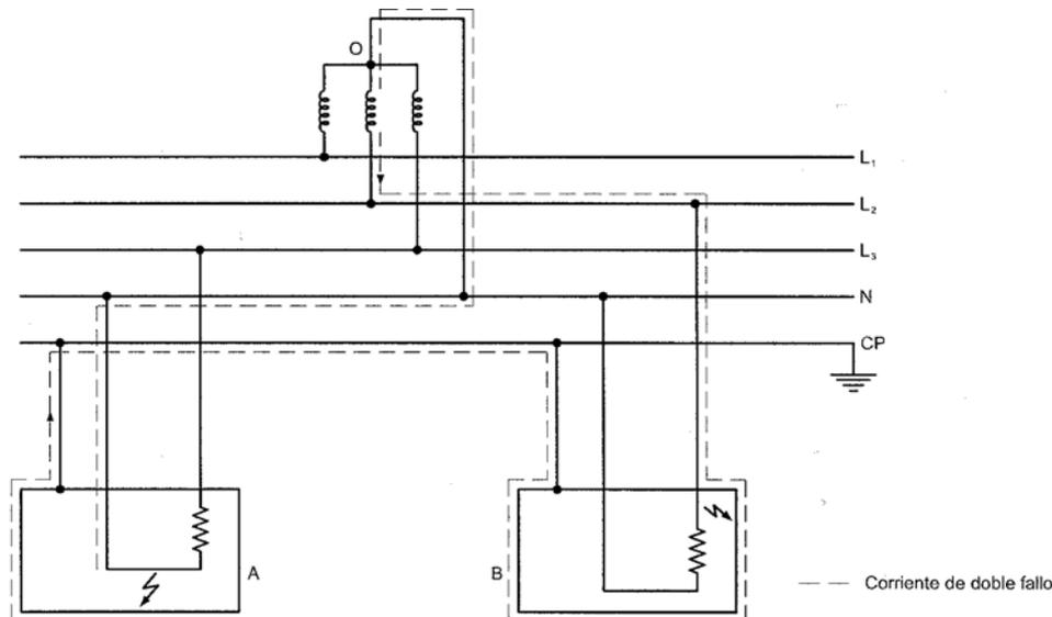
Si no es posible utilizar dispositivos de protección contra sobrecorrientes de forma que se cumpla lo anterior, se utilizarán dispositivos de protección de corriente diferencial-residual para cada aparato de utilización o se realizará una conexión equipotencial complementaria según lo dispuesto en la norma UNE 20.460 -4-41
