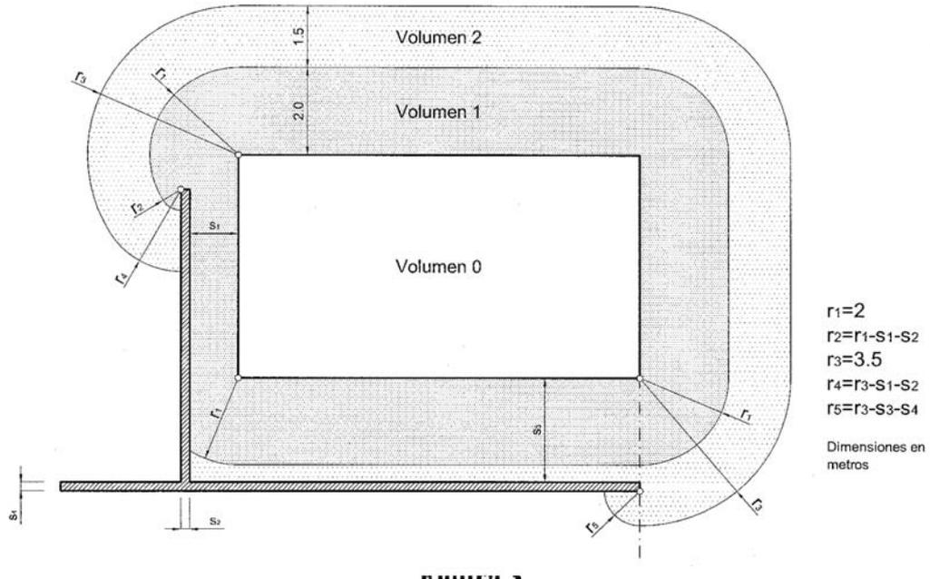
Figura 4. Volúmenes de protección en piscinas con paredes
