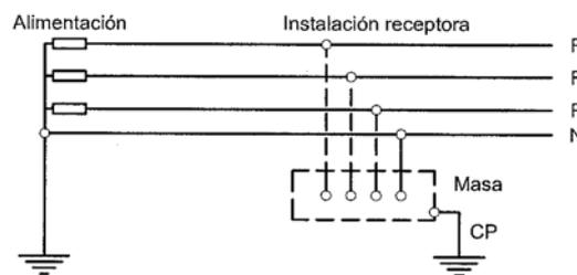
En este esquema las intensidades de defecto fase-masa o fase-tierra pueden tener valores inferiores a los de cortocircuito, pero pueden ser suficientes para provocar la aparición de tensiones peligrosas.
