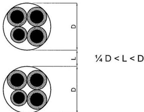
A efectos de cálculo se considera como diámetro de un cable en haz, 2,5 veces el diámetro del conductor de fase.
