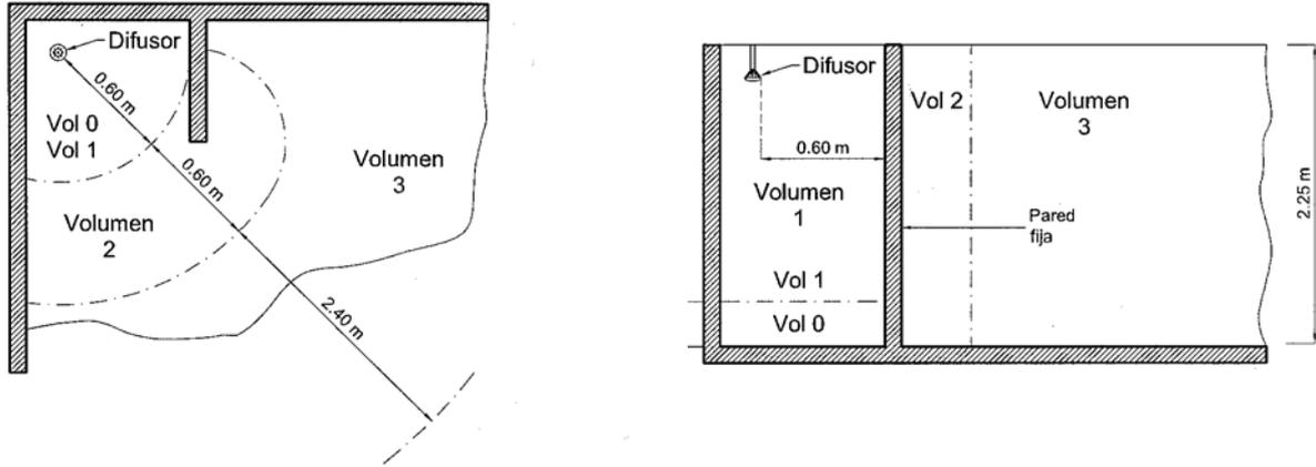
Figura 7 – CABINA DE DUCHA PREFABRICADA
